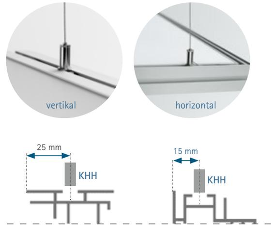
Der Schallsauger wird mit einer entsprechenden Anzahl Nutensteinen ausgeliefert. Diese befinden sich auf der zur Decke gewandten Profilseite.
