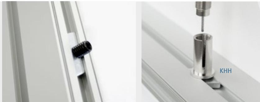
Der Deckenbefestiger (D) wird mit einer zum Untergrund passender Haltetechnik an der Decke befestigt. Die Bohrlöcher werden 25 bzw. 15 mm vom Rahmen Außenmaß nach innen versetzt.
